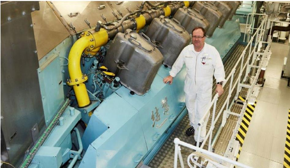
Dual-Fuel-Motor auf AIDAprima. In den gelben Leitungen strömt Flüssigerdgas zu den Zylindern.
